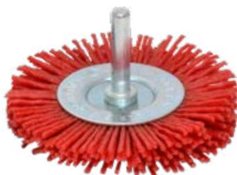
Щетка для дрели, тип «Плоская» со шпилькой, нейлоновая, зернистость Р80. Это особый тип оснастки для электроинструмента, предназначенный для работы с мягкими деликатными материалами. Применяется при зачистке и шлифовке мягких пород древесины и некоторых металлов (алюминия, меди и т. д.). Удаляет с поверхности различные загрязнения, ржавчину и заусенцы. Тип «Плоская» оптимально подходит для обработки углов, пазов, изгибов и других труднодоступных участков. Упаковка: блистер.
